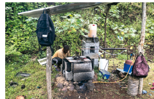
Gewinnung von Treibstoff aus Kunststoffabfällen mittels Pyrolyse.
