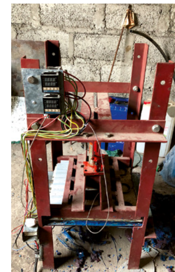
Presse chauffante pour fabriquer des panneaux à partir de déchets plastiques recyclés.
