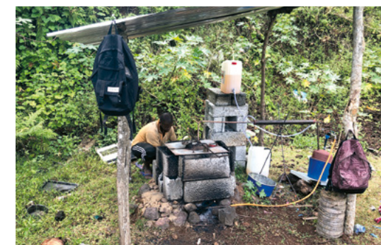
Production de carburant à partir de déchets plastiques par pyrolyse.
