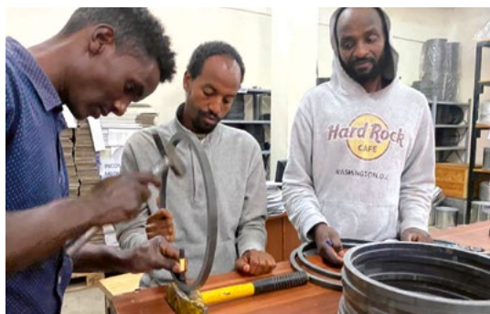
Les filtres à eau sont fabriqués à la main avec des matériaux et des minéraux généralement locaux.
