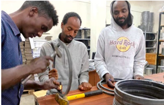
Die Wasserfilter werden von Hand mit meist lokalen Materialien und Mineralien hergestellt.
