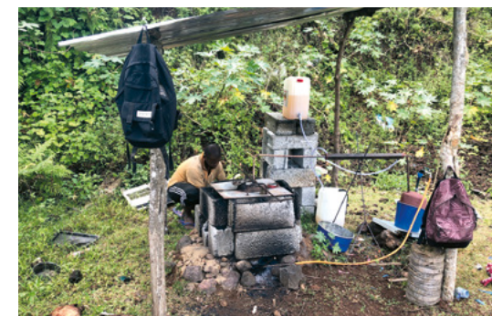
Gewinnung von Treibstoff aus Kunststoffabfällen mittels Pyrolyse.
